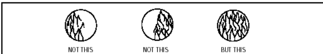
图 4. 火焰必须完全覆盖观察管全屏
